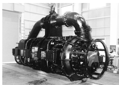
東洋水中攪乱サンドポンプ(高深度用) DP-1200-16A型 出力/900kw 重量/34トン 海の浚渫・資源採取用
